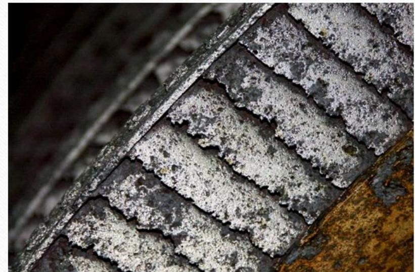
Наиболее сильный износ выходных кромок лопаток последних ступеней наблюдается у турбин, работающих длительное время на различных нагрузках, особенно на режимах холостого хода.
