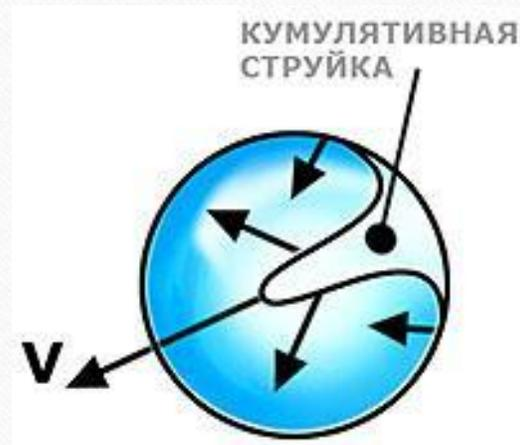
Если кавитационная каверна захлопывается вблизи от обтекаемого тела, то многократно повторяющиеся удары приводят к разрушению (к так называемой кавитационной эрозии) поверхности обтекаемого тела — лопастей гидротурбин, гребных винтов кораблей и других гидротехнических устройств.
