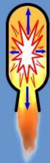
ПРИНЦИП РЕАКТИВНОГО ДВИГАТЕЛЯ
