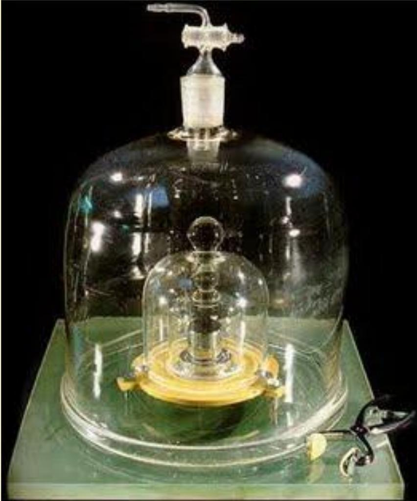
**Эталон массы изготовлен из платиново-иридиевого сплава, имеет форму цилиндра высотой примерно 39 мм.**
