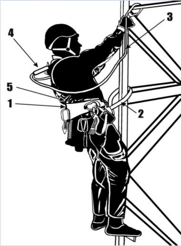
Предназначена для фиксации рабочего положения на высоте для обеспечения комфортной работы в подпоре. При этом риск падения сводится к минимуму.
