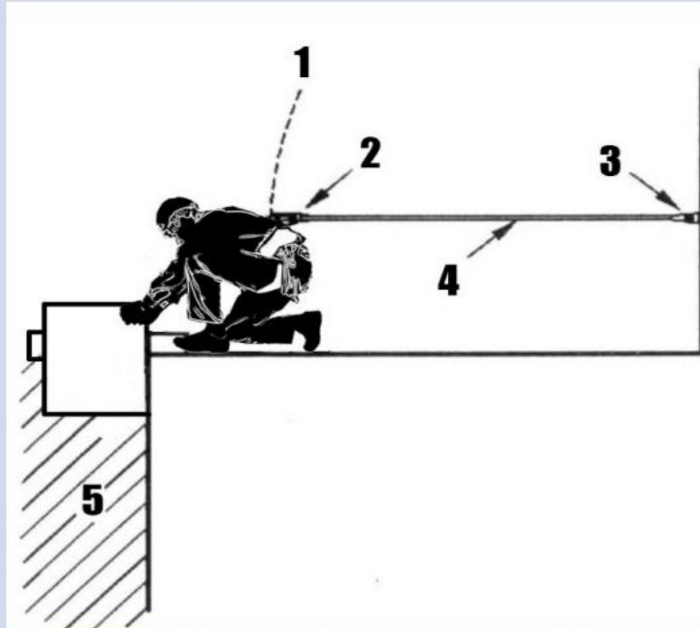
Предназначена для удержания работника таким образом, что падение с высоты предотвращается.
