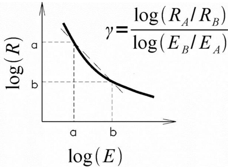
Измерив сопротивление датчика VT935G ( $R_B$ ), то можно из уравнения линии вычислить освещенность ( $E_B$ ) падающую на датчик. Выразим уравнение линии  $E_B$ :
