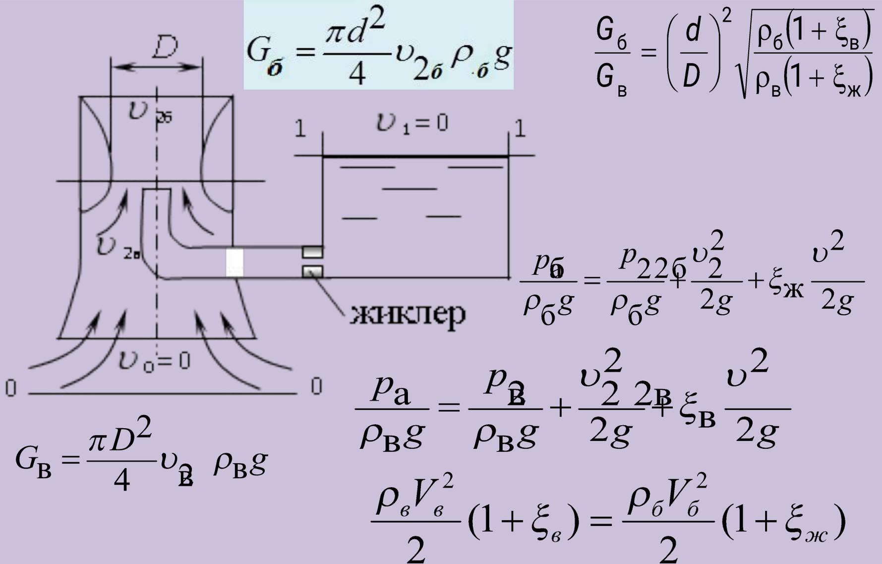
$$G_{\text{б}} = \frac{\pi d^2}{4} v_{2\text{б}} \rho_{\text{б}} g$$
