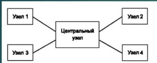
Звездообразная топология значительно упрощает взаимодействие узлов ЛВС друг с другом, позволяет использовать более простые сетевые адаптеры. В то же время работоспособность ЛВС со звездообразной топологией целиком зависит от центрального узла.
