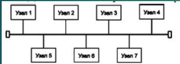
Высокое быстродействие ЛВС. Сеть легко наращивать, и конфигурировать, а также адаптировать к различным системам. Сеть устойчива к возможным неисправностям отдельных узлов, но имеет малую протяженность и не позволяет использовать различные типы кабеля в пределах одной сети. На концах сети устанавливают специальные устройства – терминаторы.
