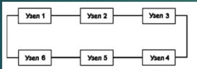
Кольцевая топология является идеальной для сетей, занимающих сравнительно небольшое пространство. В ней отсутствует центральный узел, что повышает надежность сети. В качестве **передающей среды используются любые типы кабелей**. Но последовательная дисциплина обслуживания узлов такой сети снижает ее быстродействие, а выход из строя одного из узлов нарушает целостность.
