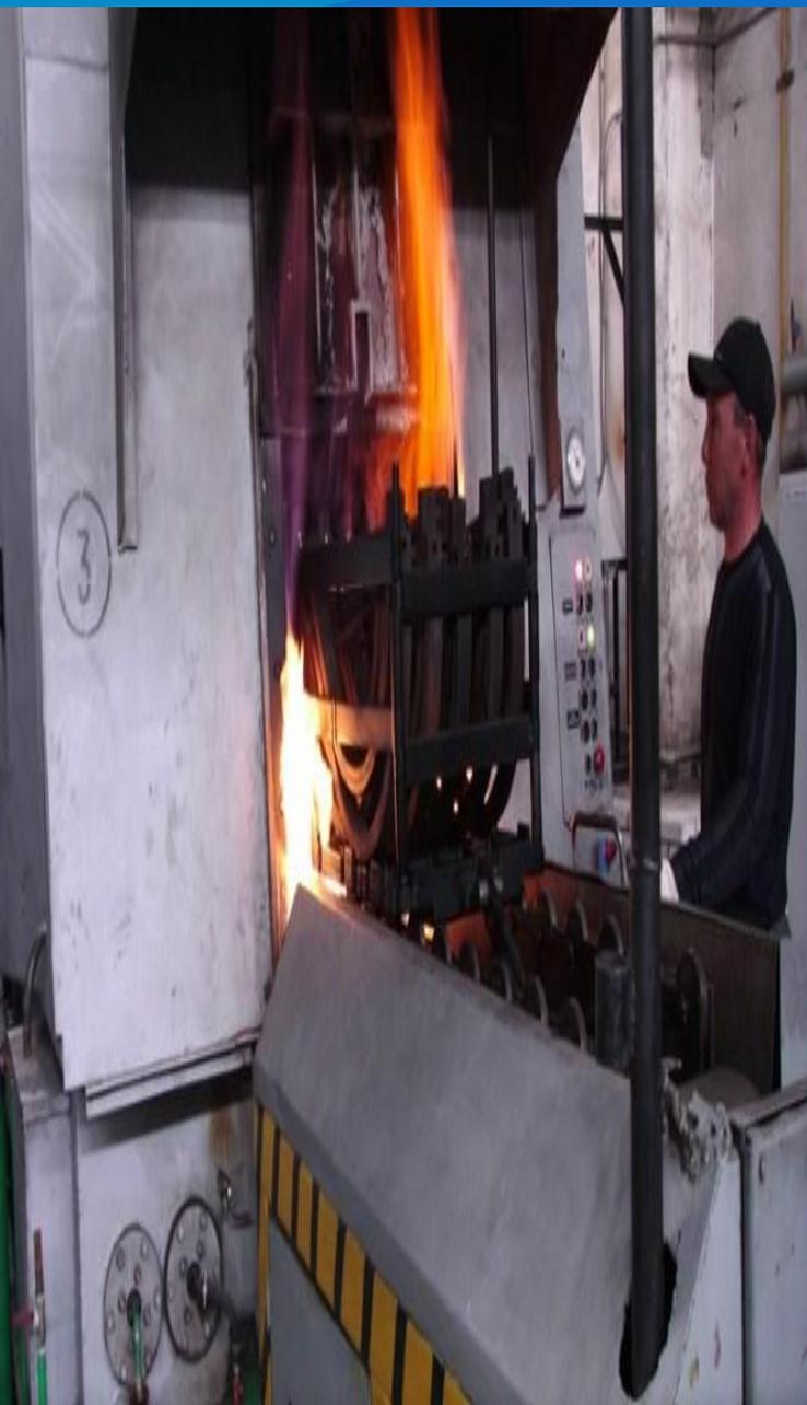
**Цианирование, целью которого является насыщение поверхностных слоев стали азотом и углеродом, представляет собой одну из разновидностей такой технологической операции, как нитроцементация.
