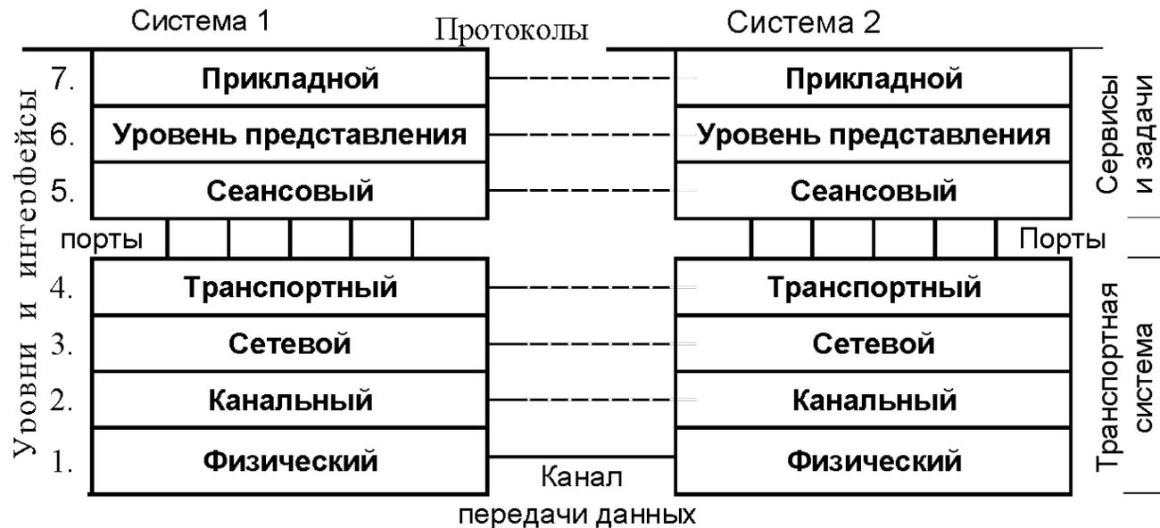
*Физический уровень* – аппаратура подключения к сети. Этот уровень обеспечивает взаимодействие со средой передачи данных на уровне сигналов (**ADSL, USB**)
