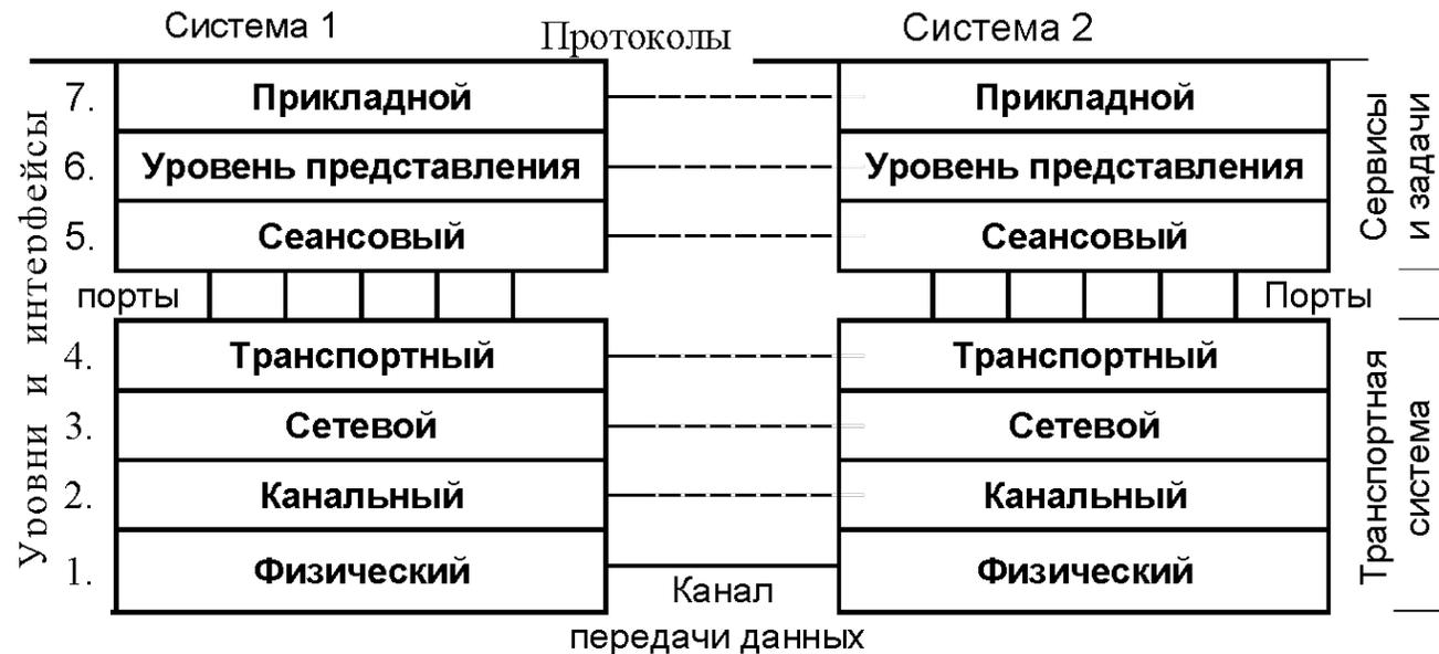
Протоколы работают друг с другом в стеке – протокол, располагающийся на уровне выше, работает «поверх» нижнего, используя механизмы инкапсуляции.
