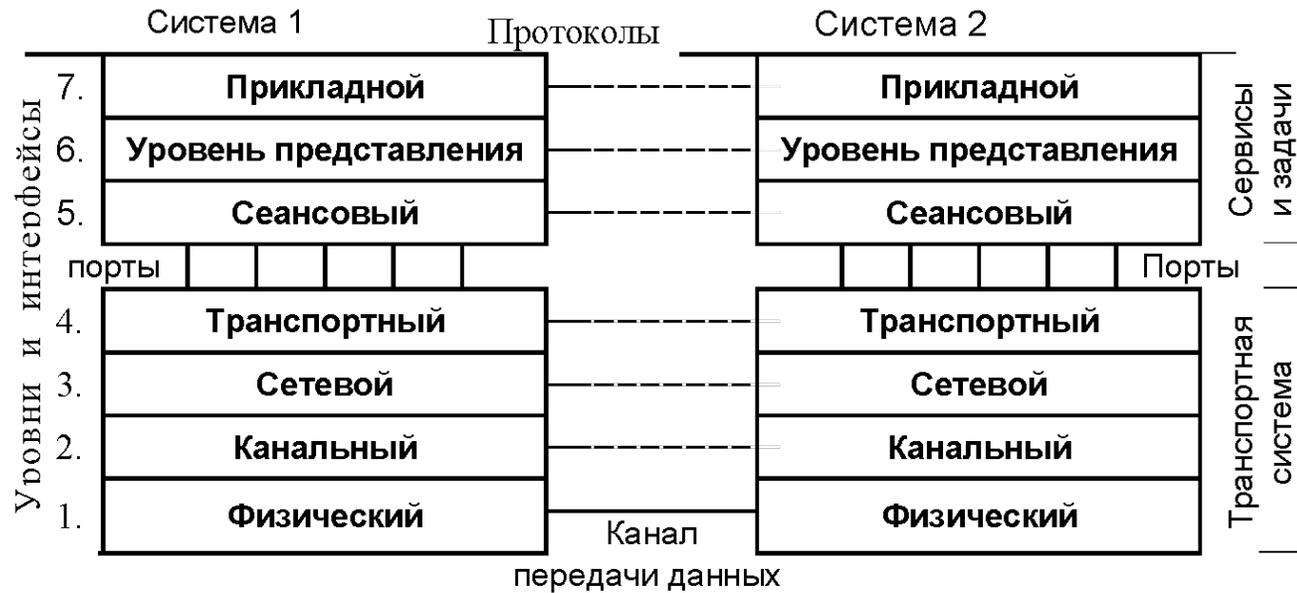
*Уровень представления* служит для преобразования форматов данных (например, вид кодировки) в соответствии с правилами ПО следующего 7-го уровня (**ASCII, JPEG**)
