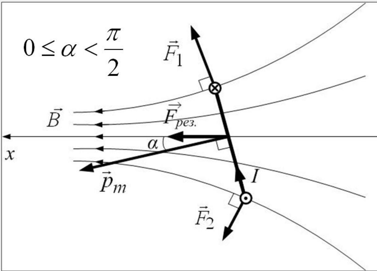
Если угол  $\alpha$  – острый, то магнитный момент втягивается в область сильного поля
