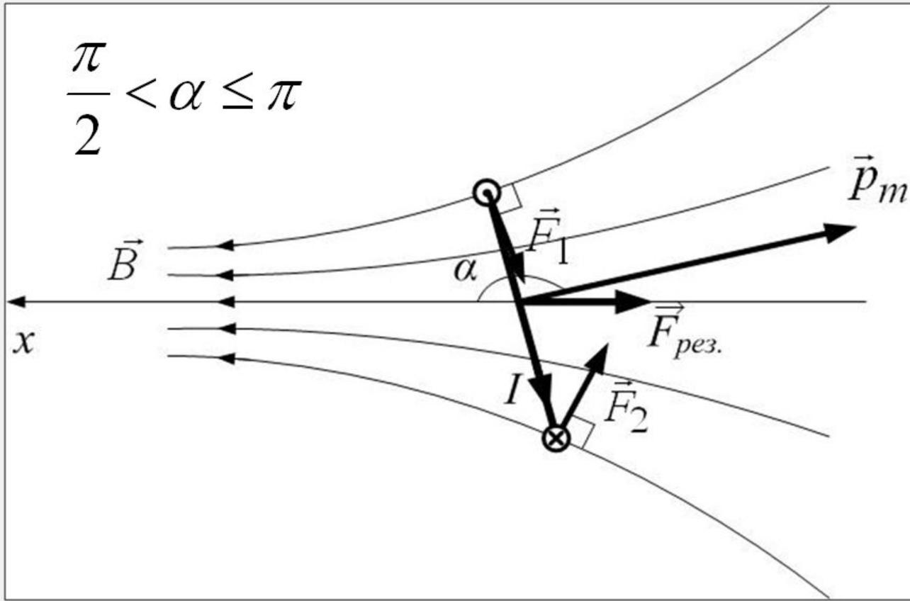
Если угол  $\alpha$  – тупой, то магнитный момент выталкивается из области сильного поля
