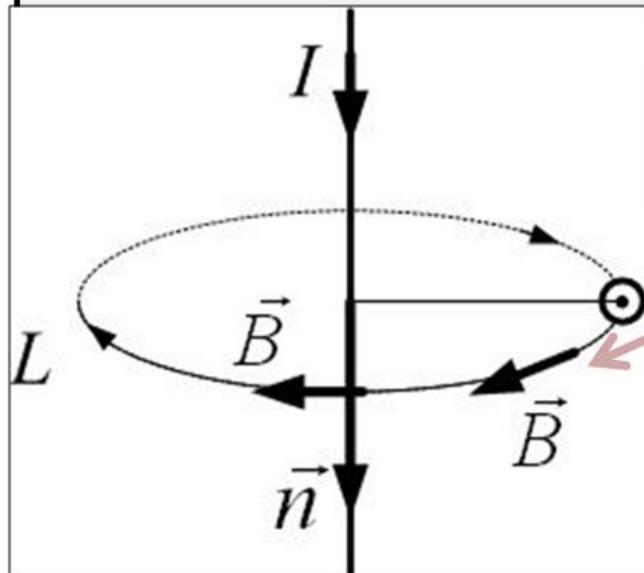
В любой точке контура вектор  $\vec{B}$  одинаков и направлен по касательной к нему
