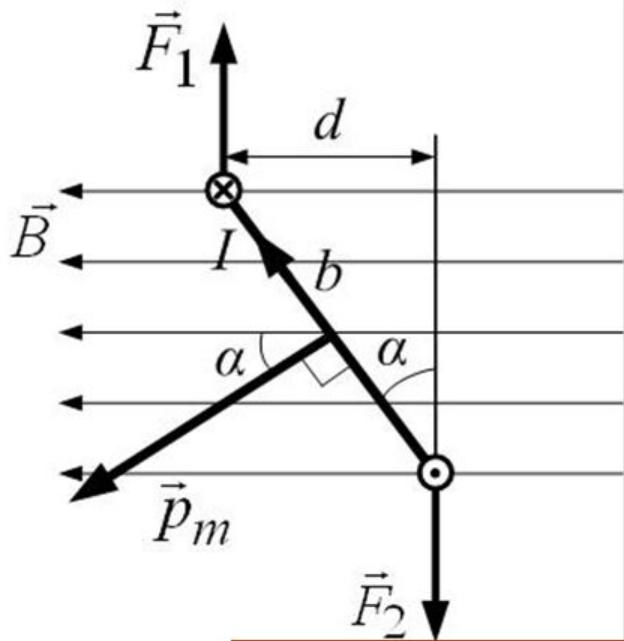
Работа внешних сил по повороту рамки с током, имеющей магнитный момент  $p_m$ , на угол  $\alpha > 0$  равна:
