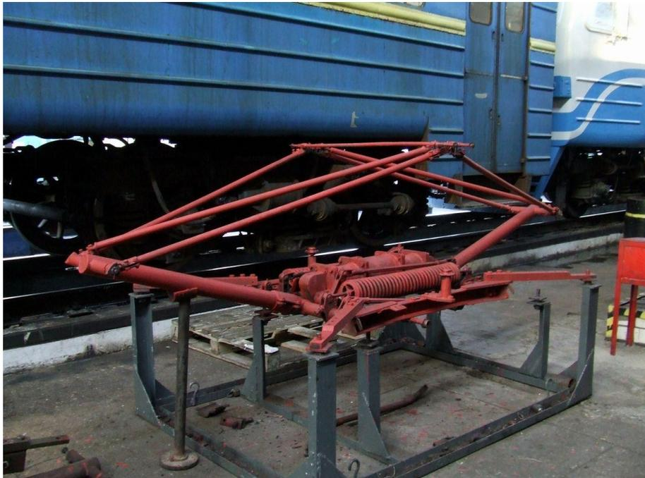
Основание рамы токоприемника установить на специальные опоры со штырями под отверстия крепления болтов опорных изоляторов, выверенных по уровню.
