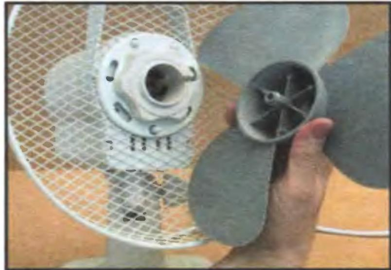
**2 Снимите пропеллер с вала**
