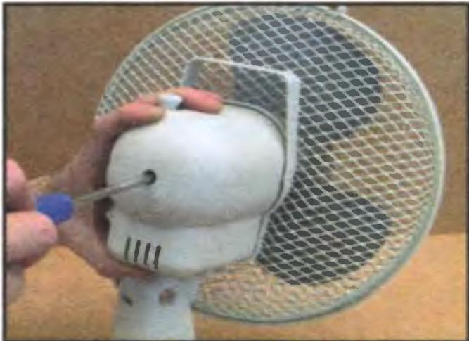
1 Снимите заднюю крышку
