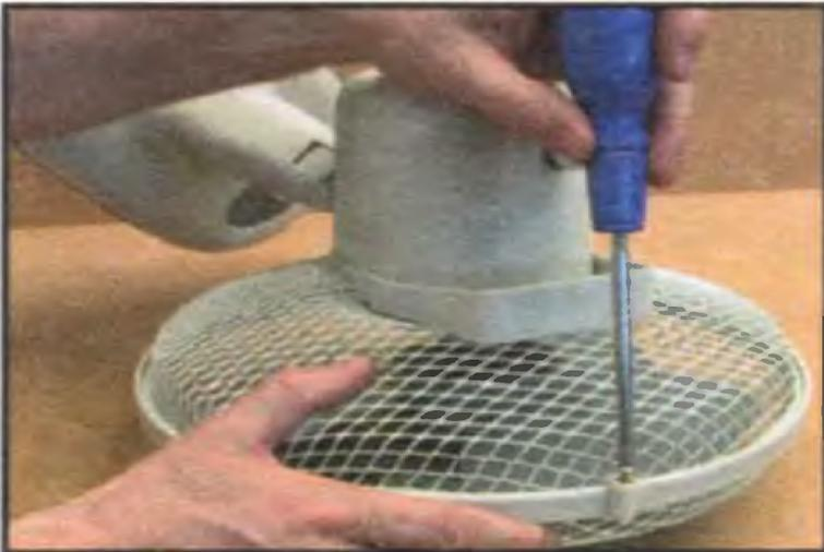
**1 Отверните винт крепления ограждения**
