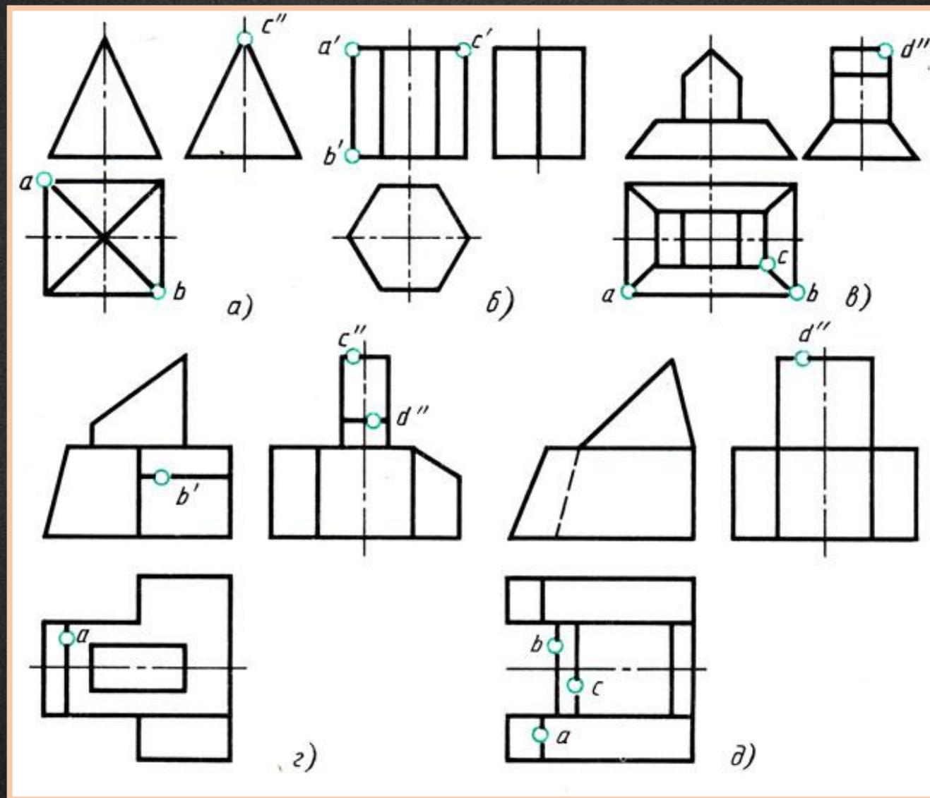
**Задание 3.** По заданным проекциям построить изометрию геометрических тел. Построить заданные точки на трех проекциях и на изометрии.
