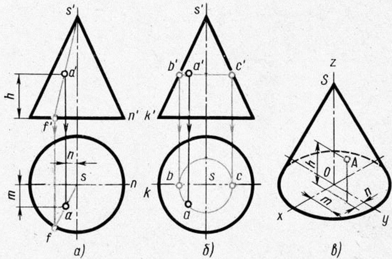
**Задание 2.** По заданным проекциям построить изометрию геометрических тел. Построить заданные точки на трех проекциях и на изометрии.
