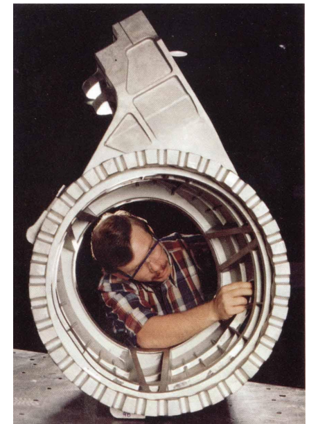
Část helikoptéry V-22 – Ti slitina
