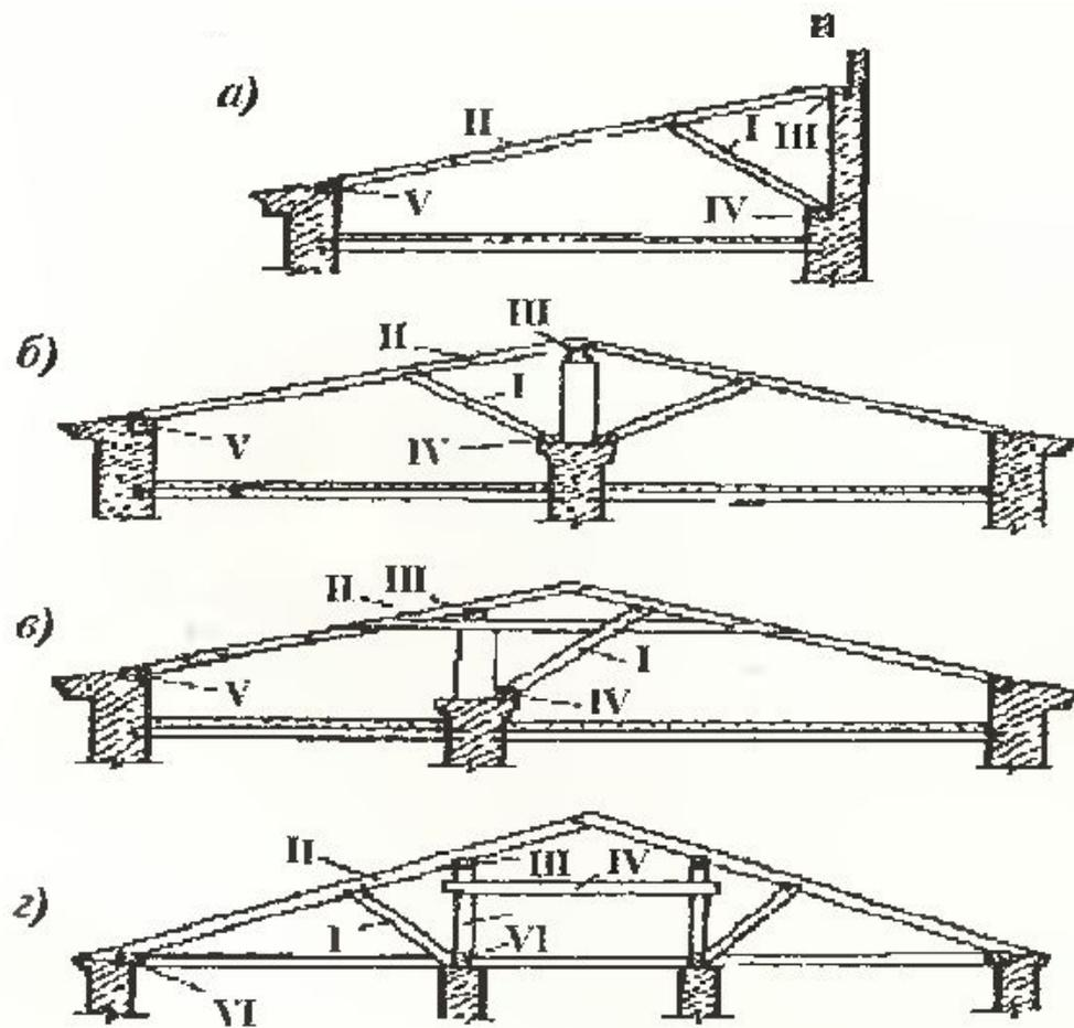
Рис. 16.12. Последовательность разборки наслонных стропил различной конструкции крыши:
