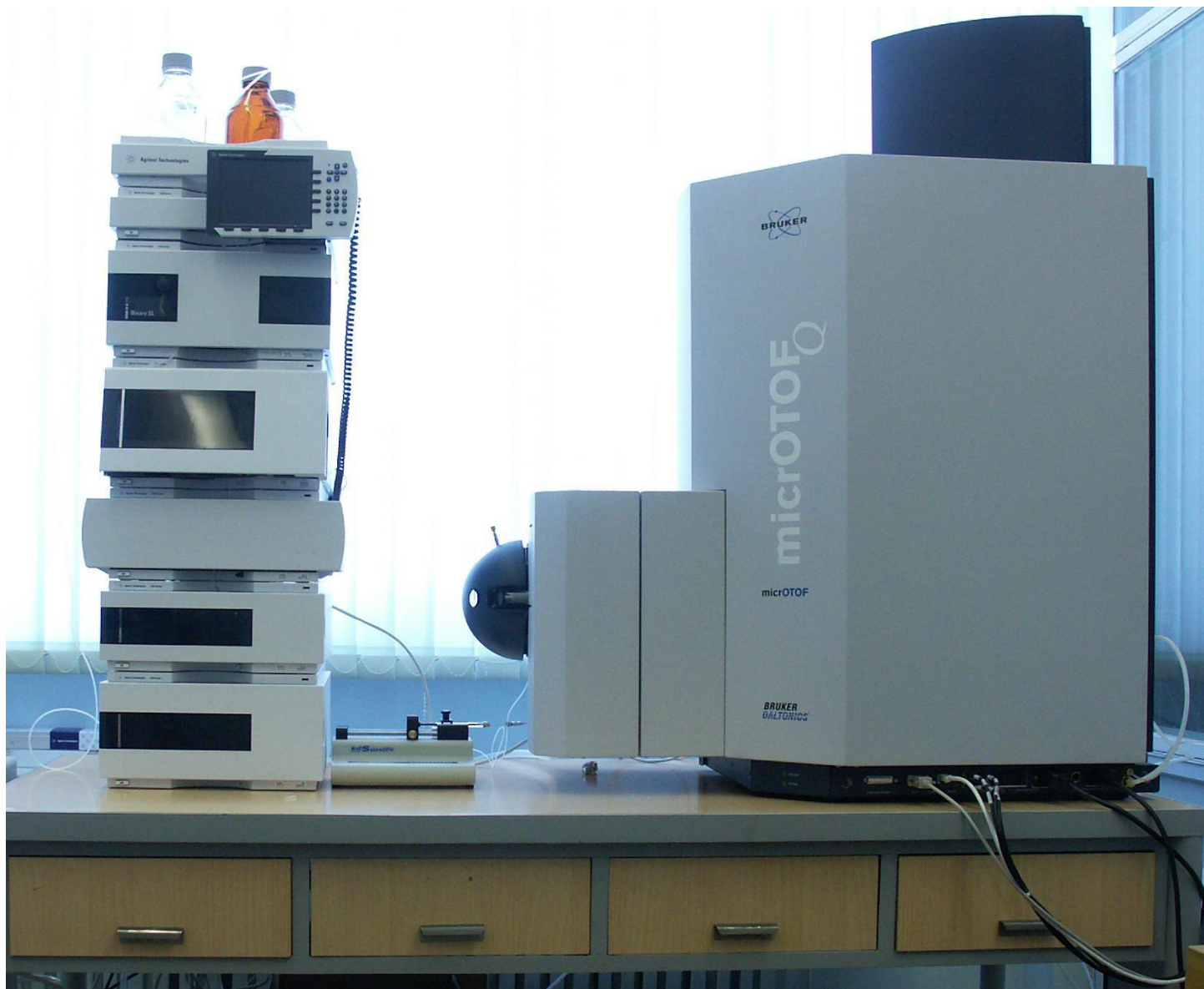
Времяпролетный масс-спектрометр высокого разрешения Bruker micrOTOF-Q с жидкостным хроматографом Agilent 1100
