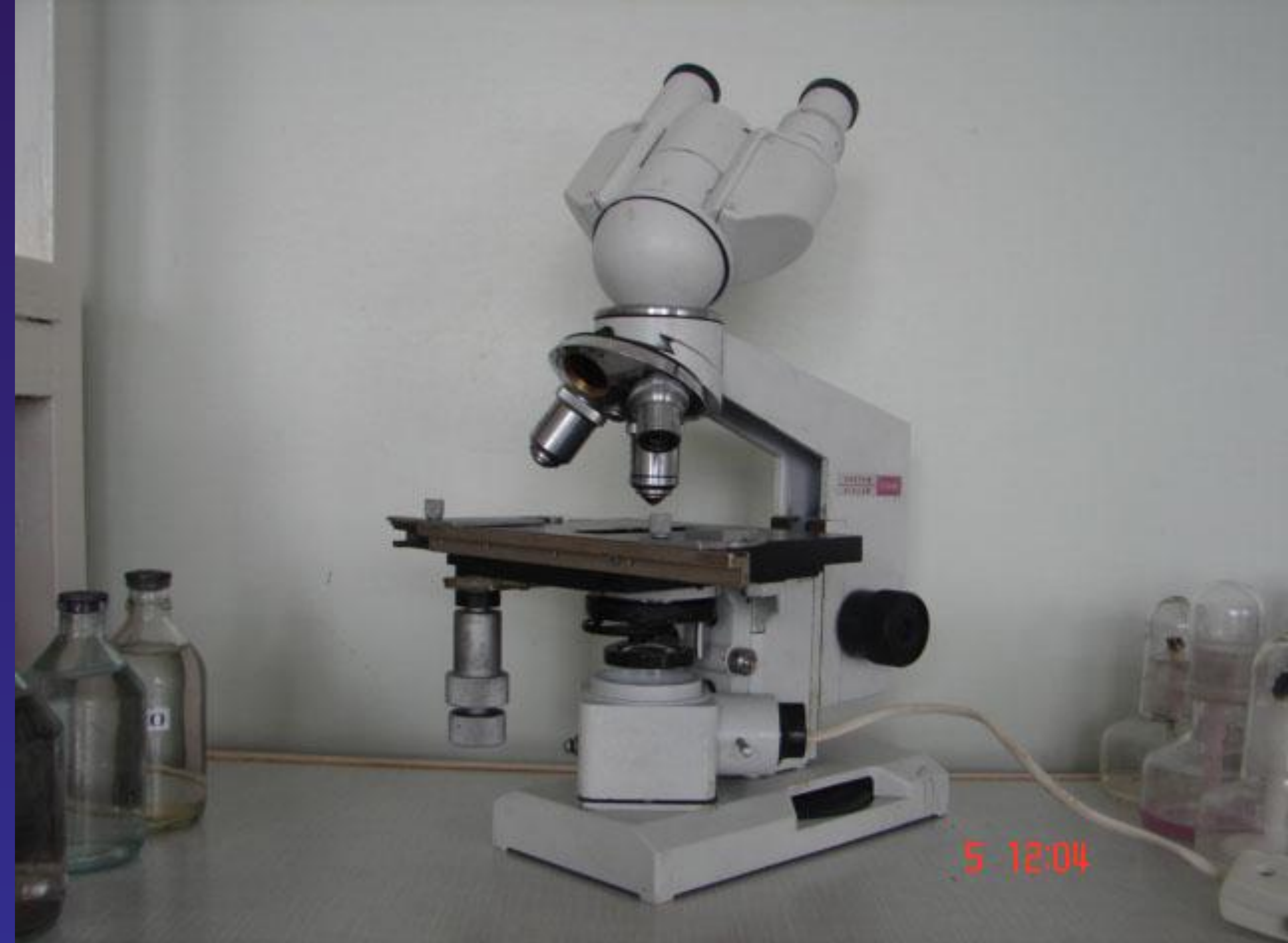
Современный световой микроскоп фирмы ЛОМО, Россия. Максимальное увеличение x1500
