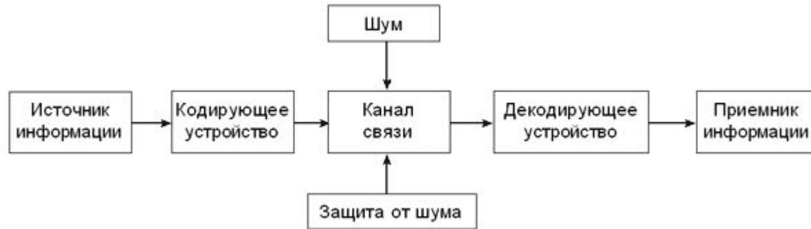
Под **кодированием** здесь понимается любое преобразование информации, идущей от источника, в форму, пригодную для ее передачи по каналу связи. **Декодирование** — обратное преобразование сигнальной последовательности.
