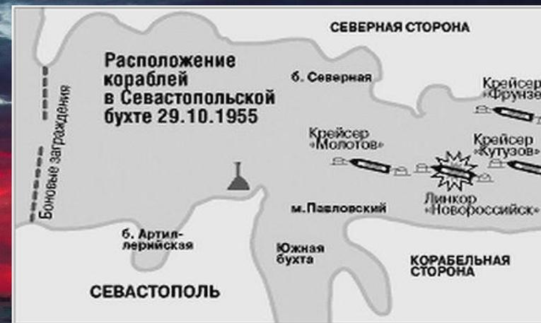
29 октября в 01:31 по московскому времени под корпусом корабля с правого борта в носу раздался мощный взрыв. По оценкам специалистов, его сила была эквивалентна взрыву 1000-1200 килограммов тринитротолуола. С правого борта в подводной части корпуса образовалась пробоина площадью более 150 квадратных метров, а с левого борта и вдоль киля — вмятина со стрелкой прогиба от 2-х до 3-х метров.
