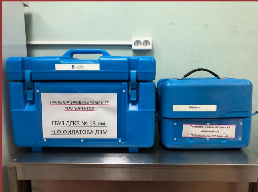
Транспортные контейнеры с эвтектической системой охлаждения для транспортировки компонентов в условиях мегаполиса
