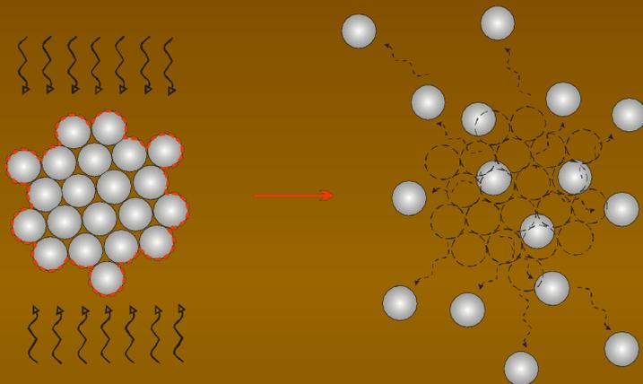
При  $v=1500\dots 2000$  м/с и  $\lambda=d_0=10\dots 100$  нм частота равна  $\nu=15\dots 200$  ГГц. При таких частотах (область гиперзвука) происходит быстрое поглощение звуковой энергии и она расходуется на различные физические процессы и преобразование вещества.
