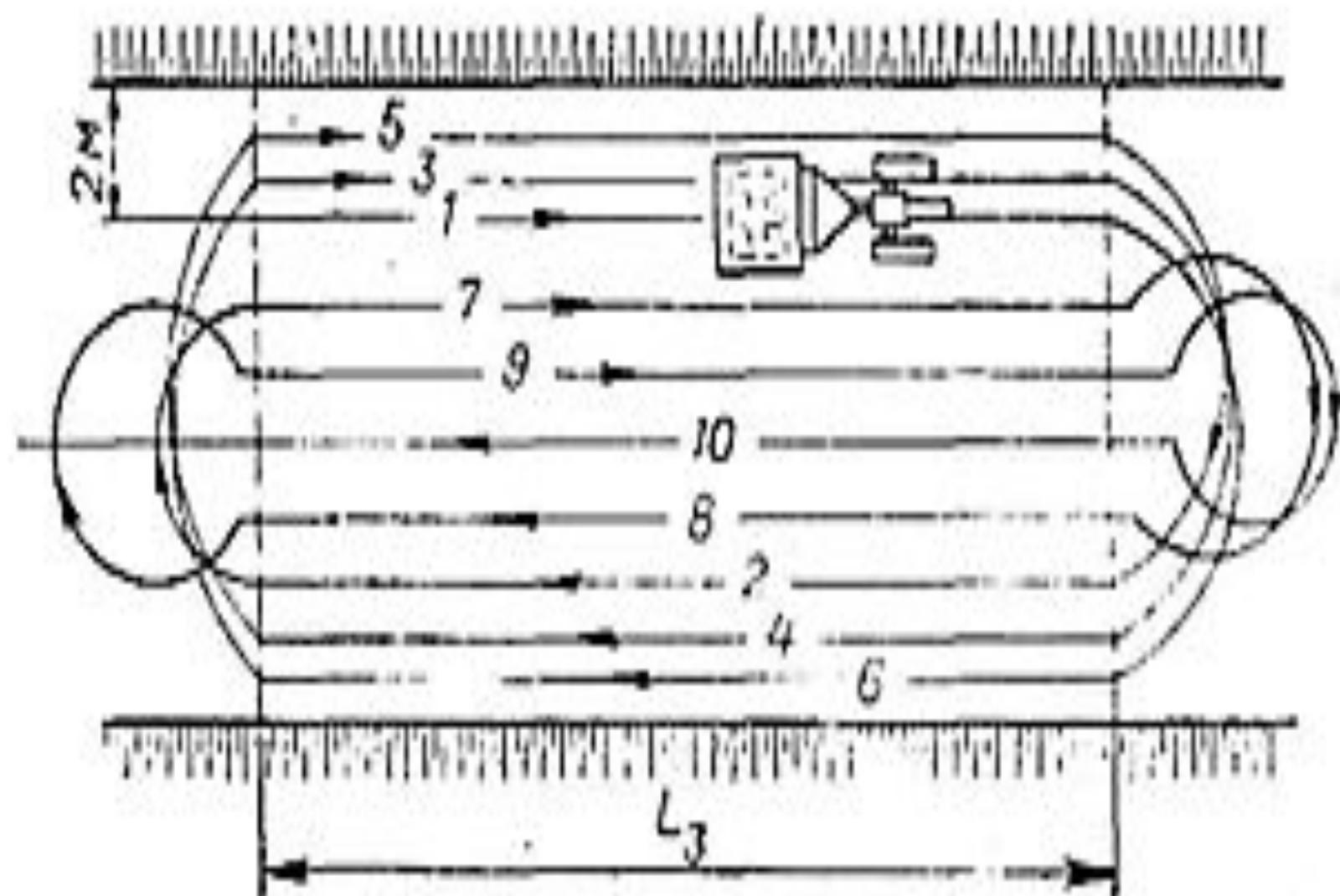
Рис. 10.7.2. Последовательность проездов катка при уплотнении вы-
