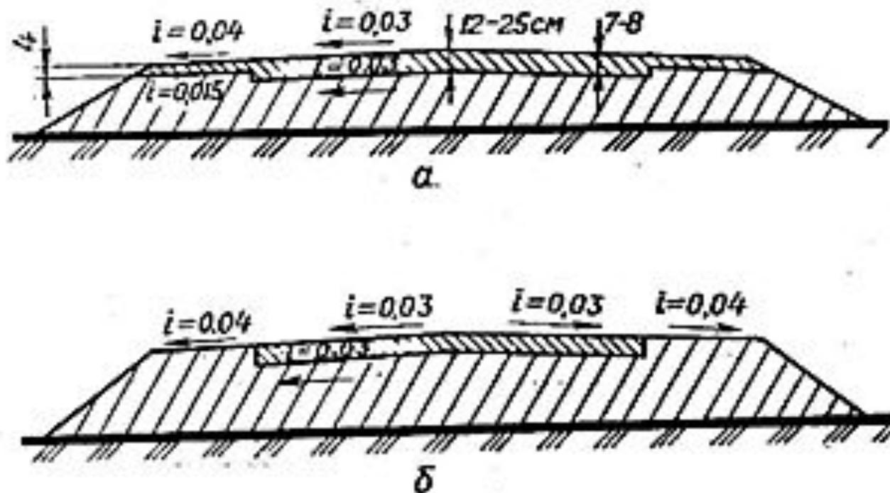
Рис. 10.8.1. Поперечные профили покрытий военно-автомобильных дорог:-
