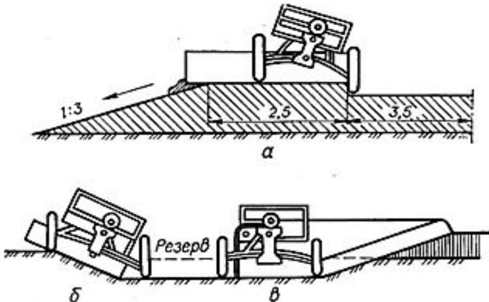
Рис. 10.8.3. Планировка земляного полотна автогрейдером:
