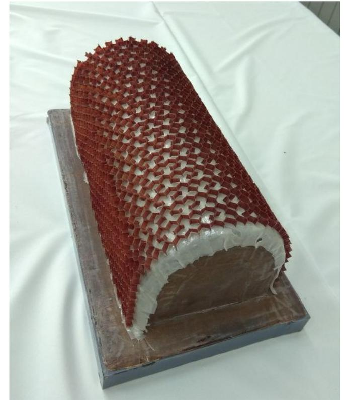
Патент № 720312. Способ изготовления композитной формообразующей оснастки для формования изделий из полимерных композиционных материалов.
