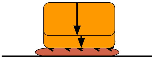
Установка механизма на виброизоляторы
