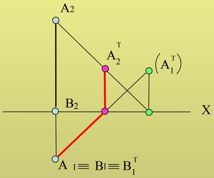
1. Тень от прямой, параллельной плоскости проекций, параллельна и равна самой прямой.
