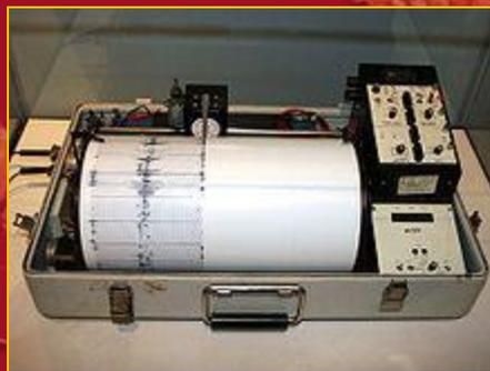
**Сейсмограф** — специальный измерительный прибор, который используется для обнаружения и регистрации всех типов сейсмических волн.
