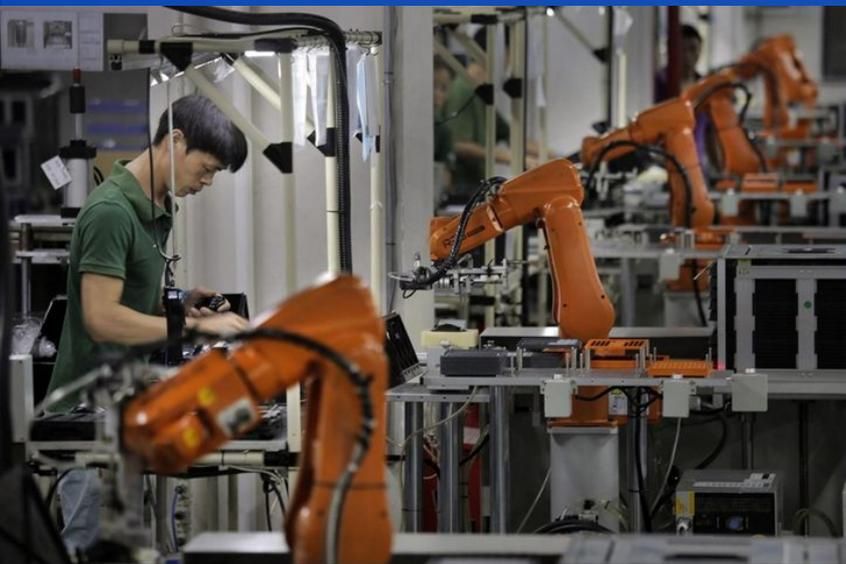
Промышленный робот – это механическая система, включающая манипуляционные устройства, систему управления, чувствительные элементы и средства передвижения. 📢
