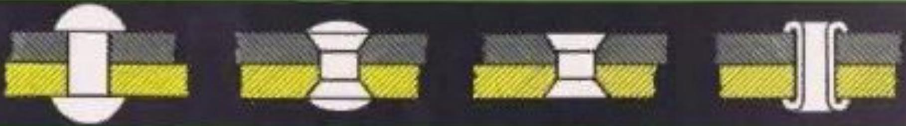
**Заклепка** представляет собой цилиндрический стержень из пластичного металла, на одном конце которого выполнена головка, называемая **закладной**.
