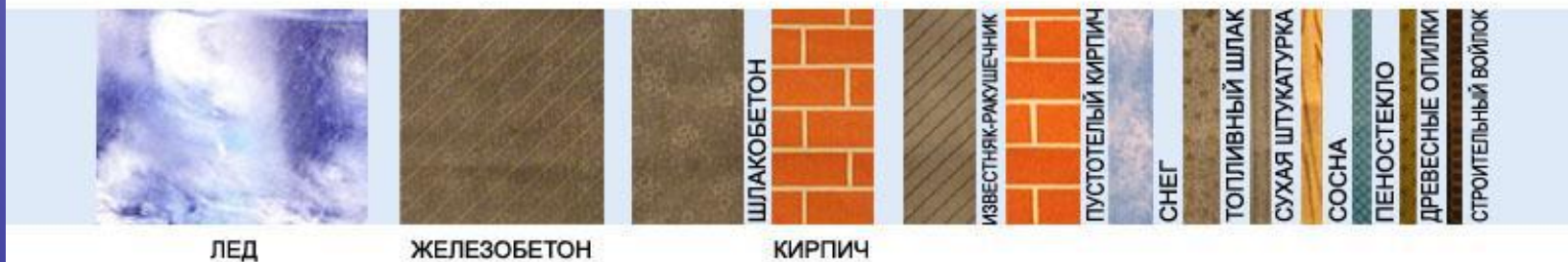
ШКАЛА ТОЛЩИНЫ МАТЕРИАЛОВ ПРИ ОДИНАКОВОЙ ТЕПЛОПРОВОДНОСТИ
