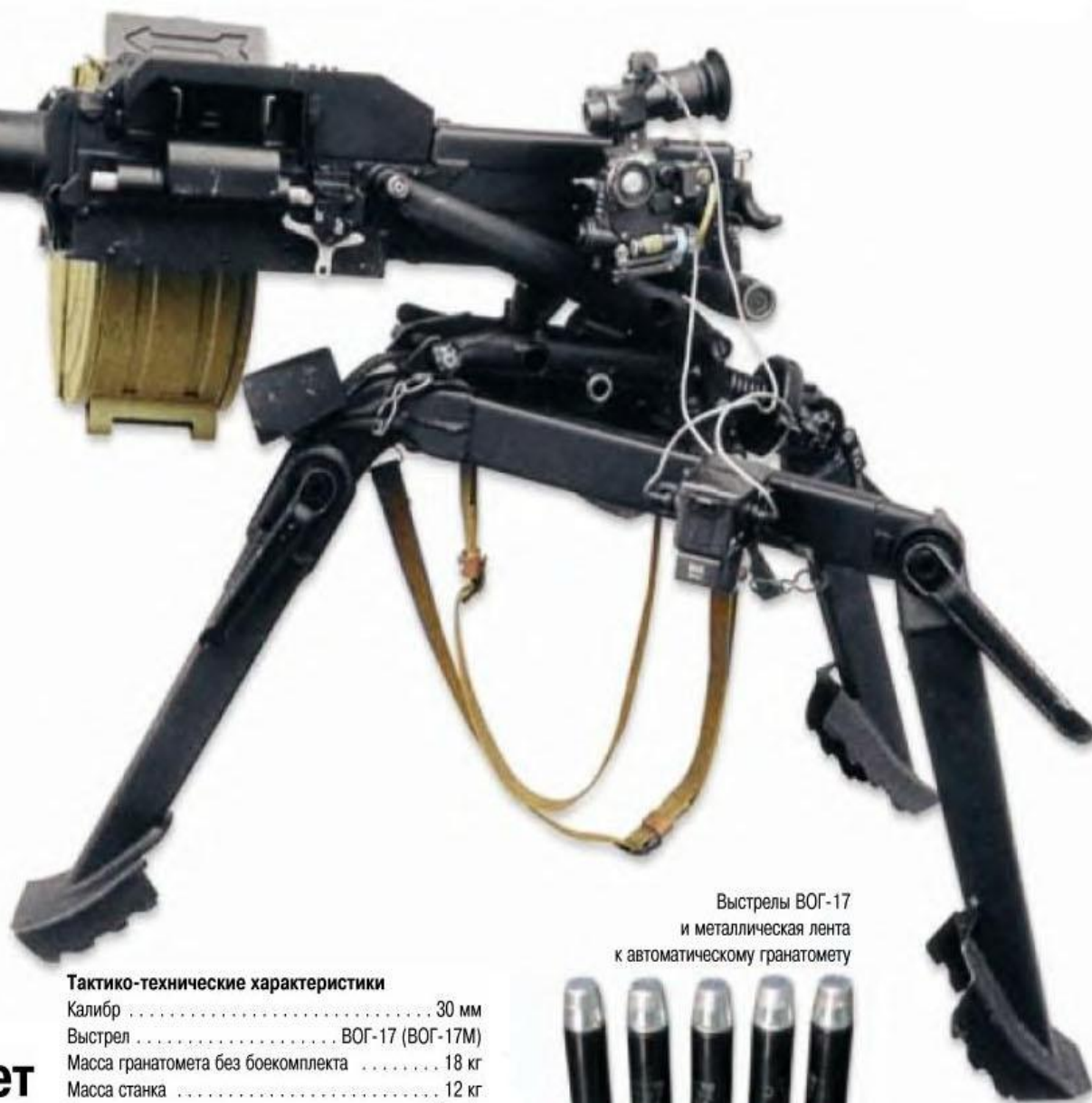
Автоматический станковый гранатомет АГС-17
