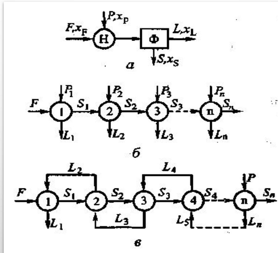
СХЕМЫ ПОТОКОВ ПРИ ОДНОКРАТНОМ (А), ПОРЦИОННОМ (Б) И ПРОТИВОТОЧНОМ (В) ЧАСТИЧНОМ РАСТВОРЕНИИ.
