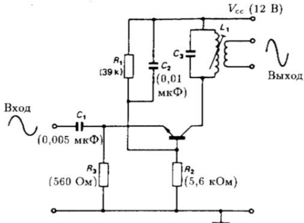
При уменьшении входного сигнала потенциал эмиттера уменьшается относительно потенциала базы, ток  $I_c$  увеличивается и увеличивает падение напряжения на коллекторном резисторе. В результате уменьшается выходное напряжение. Таким образом, усилитель с ОБ не изменяет фазу входного сигнала при его усилении.
