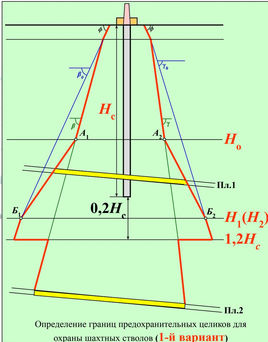
**По первому варианту**, т. е. когда в пределах предохранительных целиков **имеются** ранее пройденные **очистные выработки**, границы предохранительных целиков определяются линиями пересечения пластов плоскостями, проведенными:
