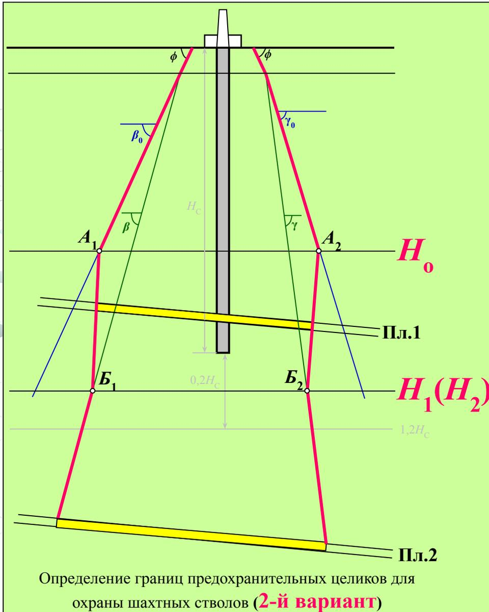
**По второму варианту**, т.е. в случаях, когда ранее пройденные **очистные выработки** в пределах предохранительных целиков **отсутствуют**, границы предохранительных целиков определяются линиями пересечения пластов плоскостями, проведенными:
