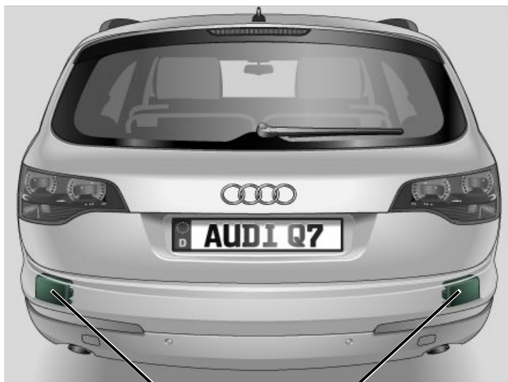
Места установки блоков управления
