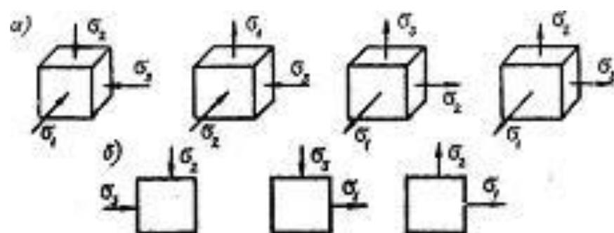
**Схема напряженного состояния:**
