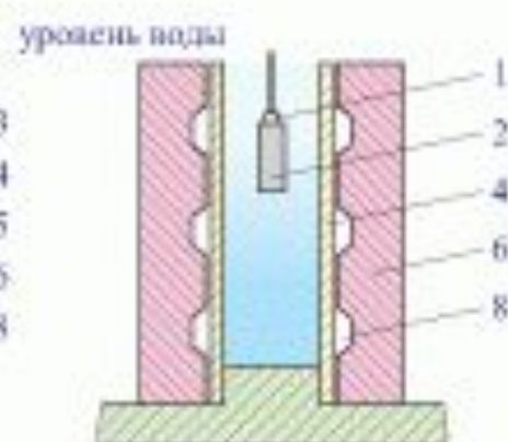
а - свободное формообразование; б - штамповка в матрице; в - штамповка трубных заготовок; 1 - детонатор; 2 - взрывчатое вещество; 3 - резервуар; 4 - заготовка; 5 - прижимная плита; 6 - матрица; 7 - бустер; 8 - линия вакуум-насоса
