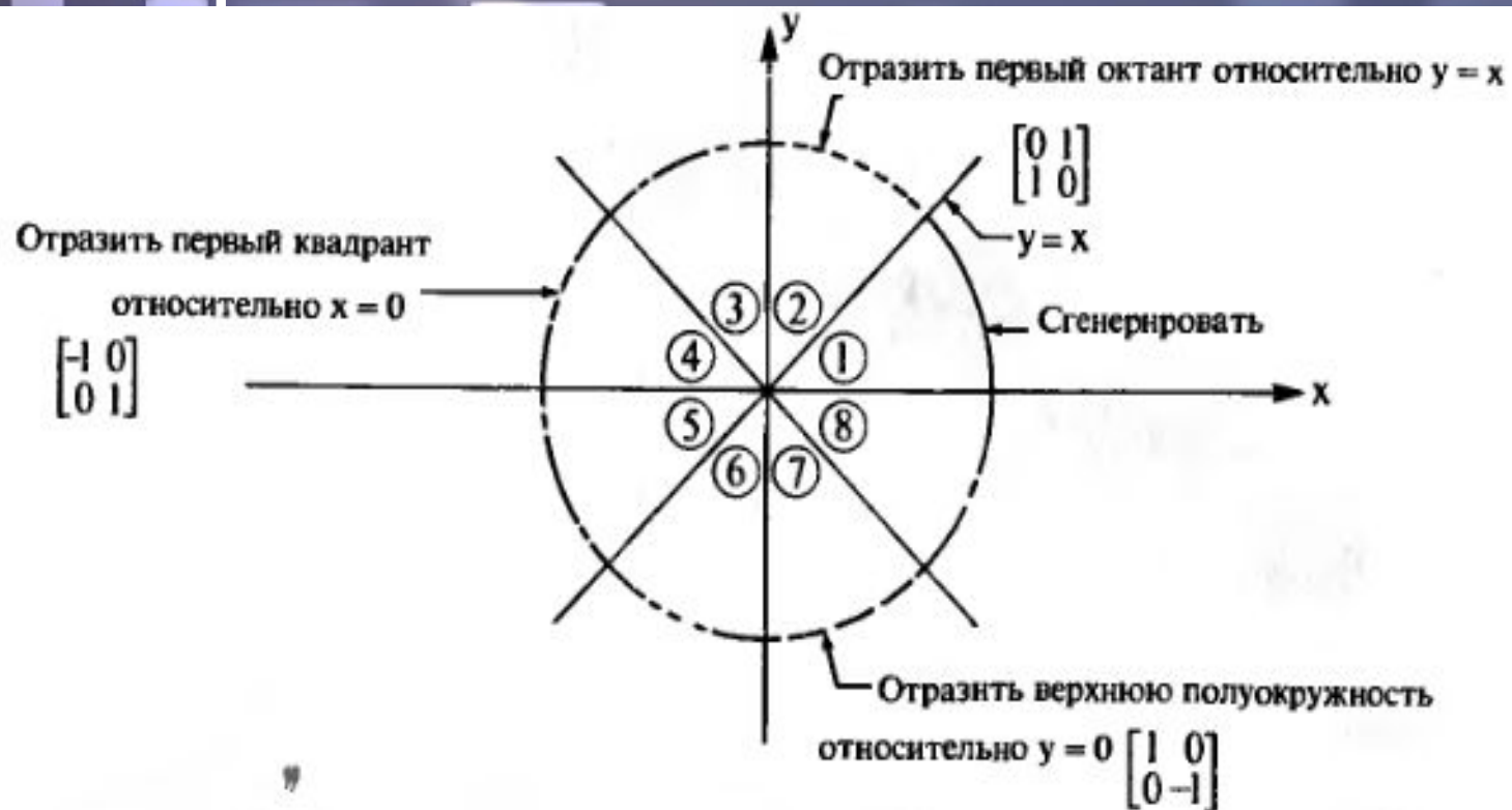
Рис. Генерация полной окружности из дуги в первом октанте.
