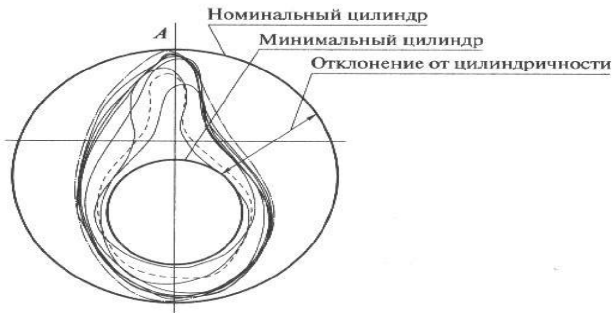
Рис. 1.8. Профиль валика диаметром 16 мм, измеренный в отклонениях
