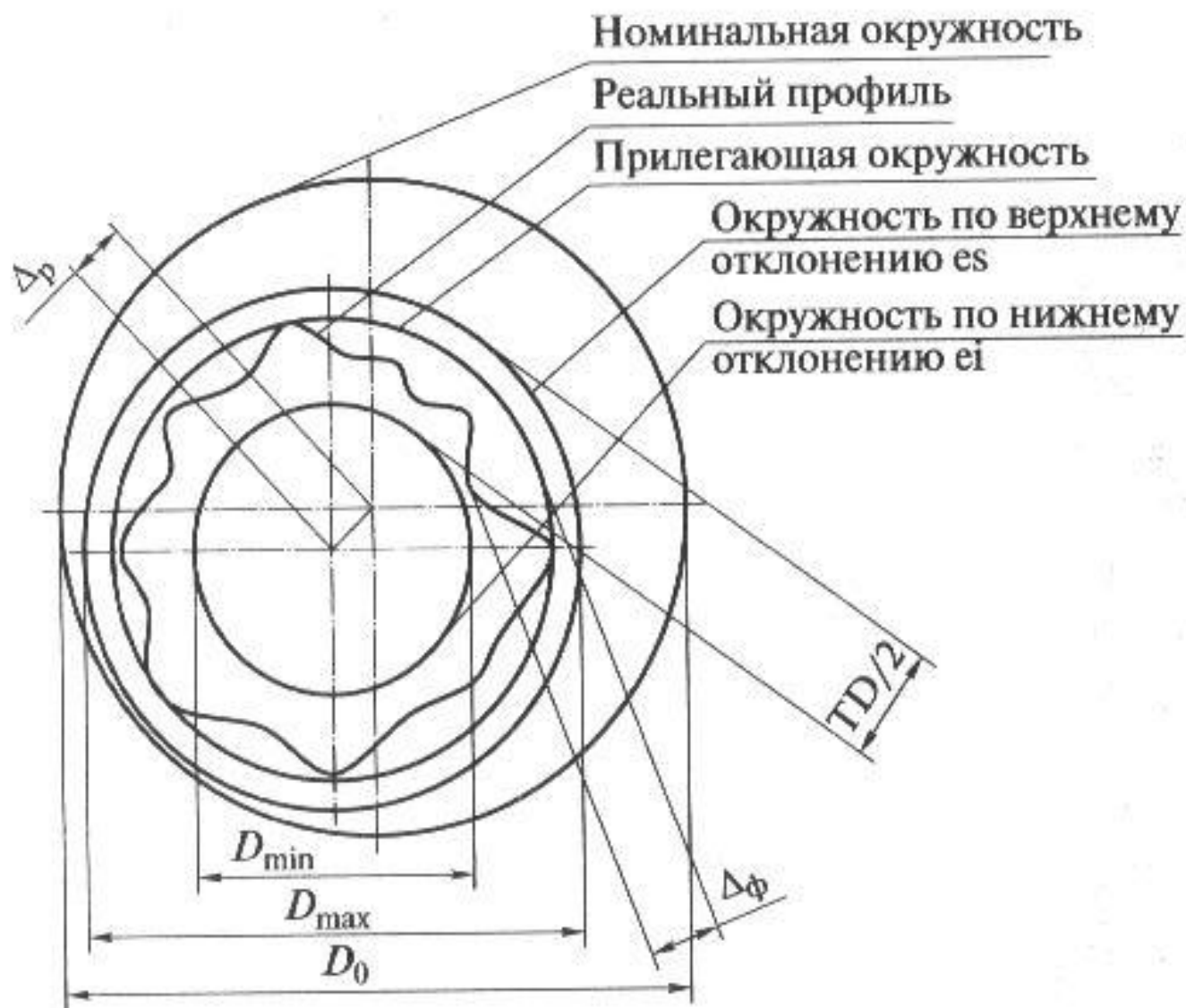
Рис. 1.9. Геометрическое представление погрешностей номинального размера, формы и расположения в сечении цилиндрической поверхности вала
