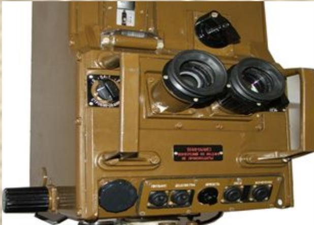
**Углоизмерительная платформа (УИП)** (рис.3.1.3) предназначена для измерения горизонтальных углов и закрепления приёмопередатчика.
