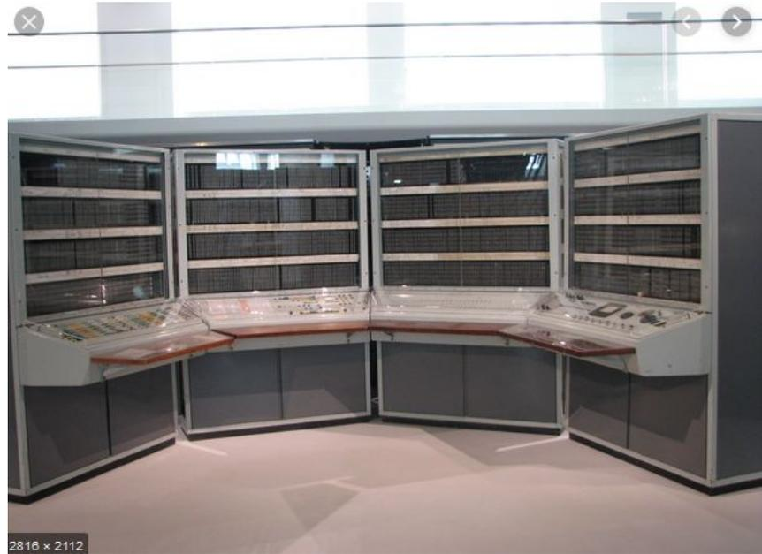
В СССР в 1967 году вступила в строй наиболее мощная в Европе ЭВМ второго поколения (БЭСМ 6 – Быстродействующая Электронная Счётная Машина 6), которая могла выполнять 1 миллион операций в секунду, в ЭВМ БЭСМ 6 использовались 60 тыс. транзисторов и 200 ты. Полупроводниковых диодов
