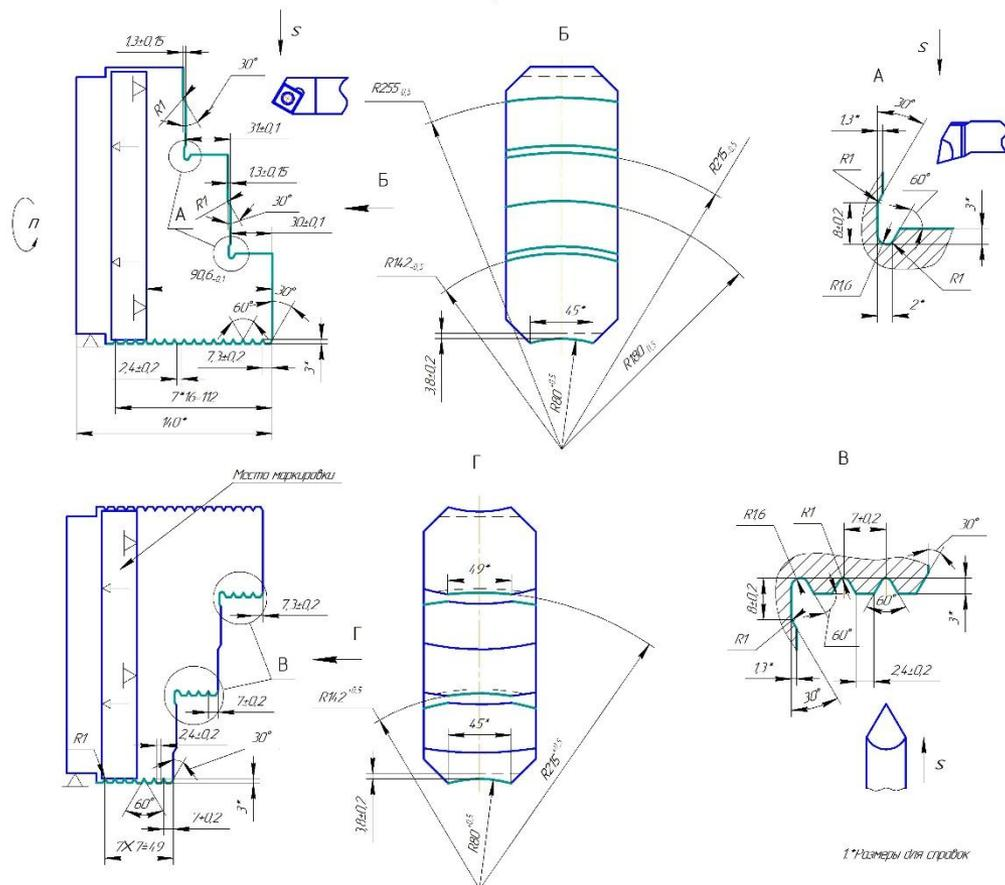
1. Точить поверхности выдержав р-ры: 90,6<sub>±0,1</sub>; 30<sub>±0,1</sub>; 31<sub>±0,1</sub>; 13<sub>±0,15</sub>; R142<sub>±0,5</sub>; R180<sub>±0,5</sub>; R215<sub>±0,5</sub>; R255<sub>±0,5</sub>.
