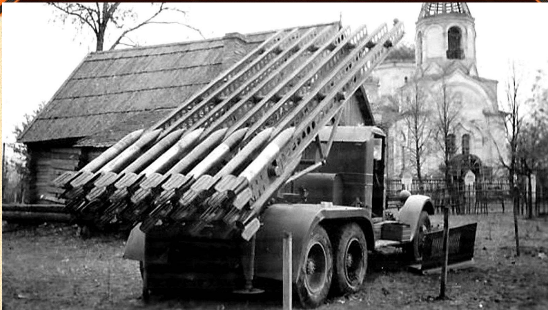
Одна из первых серийных боевых систем БМ-13 в районе Старой Руссы. Август–сентябрь 1941 года
