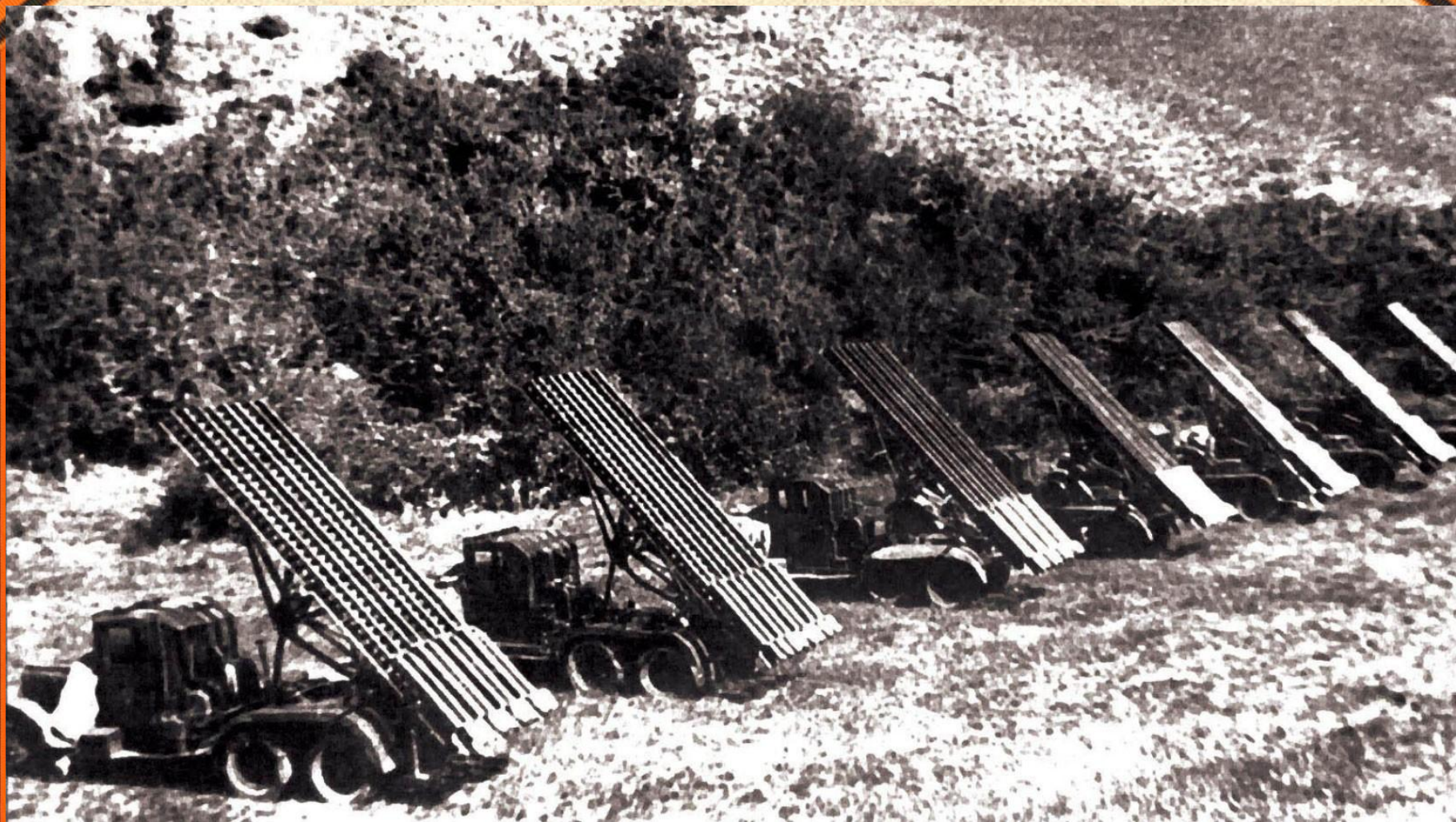
Батарея первых боевых машин БМ-13-16 с продольными направляющими. Осень 1941 года
