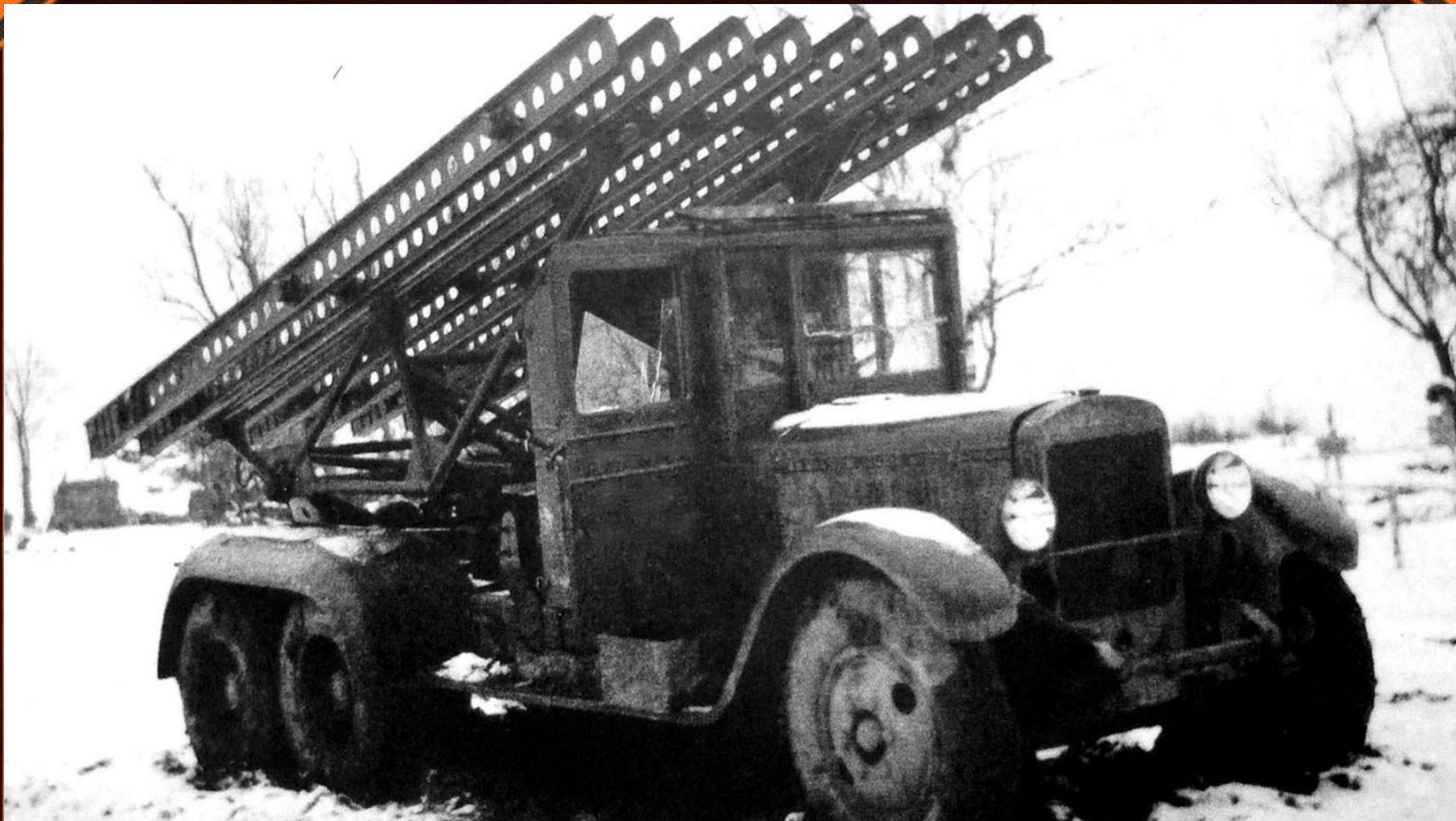
Пусковая установка БМ-13-16 из первой партии завода «Компрессор». Зима 1941–1942 года
