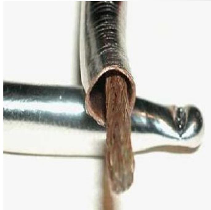
Превышение максимально допустимой мощности любого элемента электрической цепи приводит с течением времени к его разрушению.
