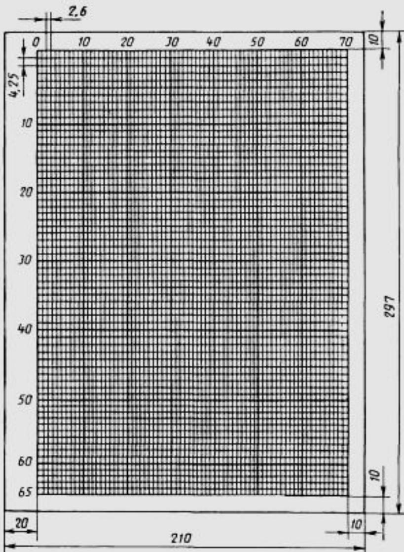
Линии конструкционной сетки имеют *порядковые номера*.
