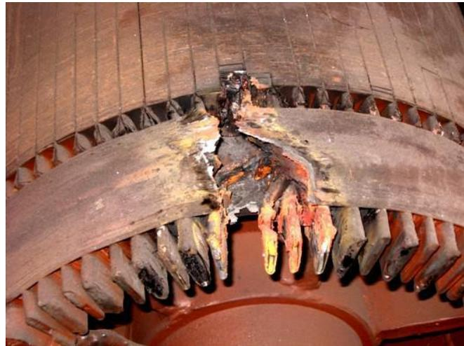
Разрушение корпусной изоляции с выжиганием части активного железа
