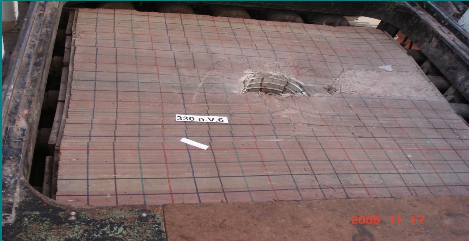
Готовую модель помещают в горизонтально расположенные гидравлические прессы. На этих прессах моделируют вертикальные и горизонтальные нагрузки на моделируемый горный массив, и сформированные в нем выработки. Для моделирования наличия горного массива с фронтальной плоскости на модель при испытании укладывают утяжеленные маты.
