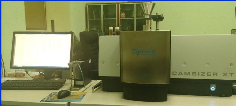
Диапазон измерений: с картриджем "X-Fall" – 10 мкм - 3 мм; с картриджем "X-Jet" – 1 мкм - 1.5 мм.
