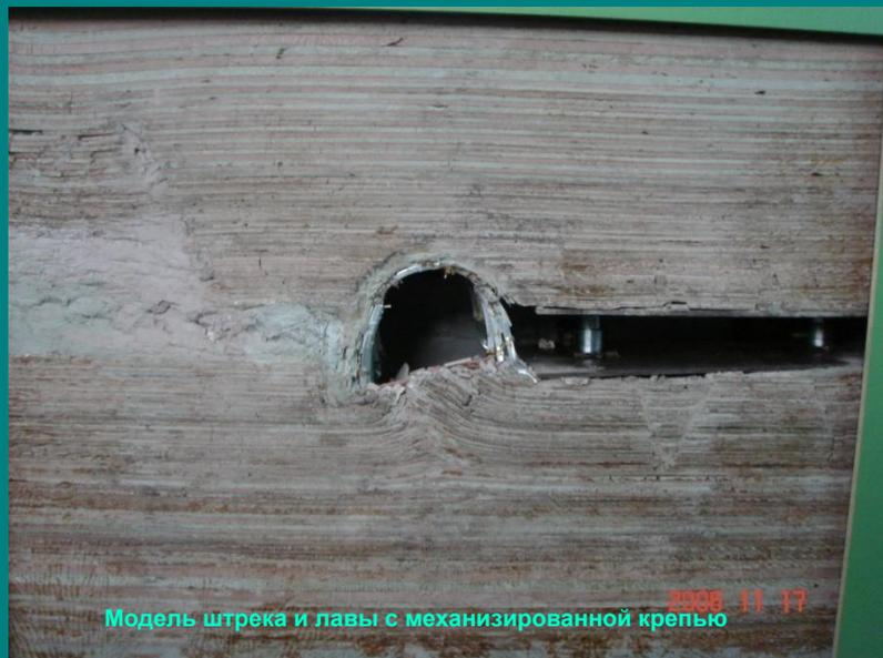
Результаты моделирования используются для тарировки моделей из конечных элементов. Сформированные модели конечных элементов применяются для аналогичных горно-геологических условий, позволяют получить объективные результаты.
