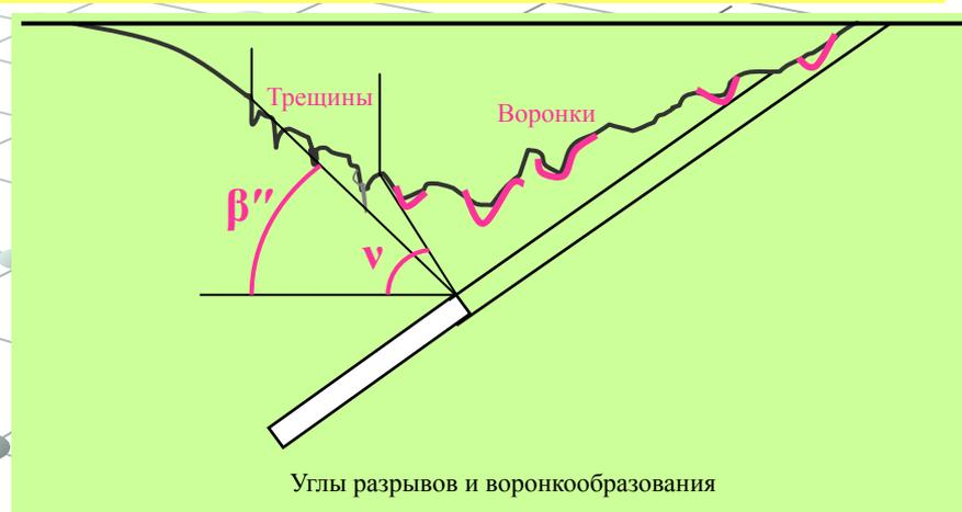
При разработке рудных месторождений на земной поверхности могут возникать зоны воронкообразования, террас, трещин; при разработке угольных месторождений в мульде может образоваться зона провалов, преимущественно над верхней границей выработки при глубине очистной выработки (20-30) $m$ , где  $m$  – вынимаемая мощность.
