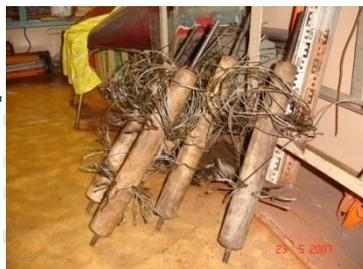
**Общий вид изготовленных глубинных реперов**
