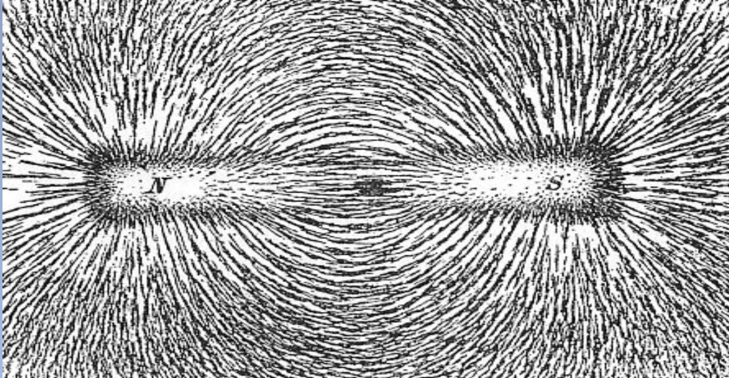
Картина силовых линий магнитного поля, создаваемого постоянным магнитом в форме стержня.
