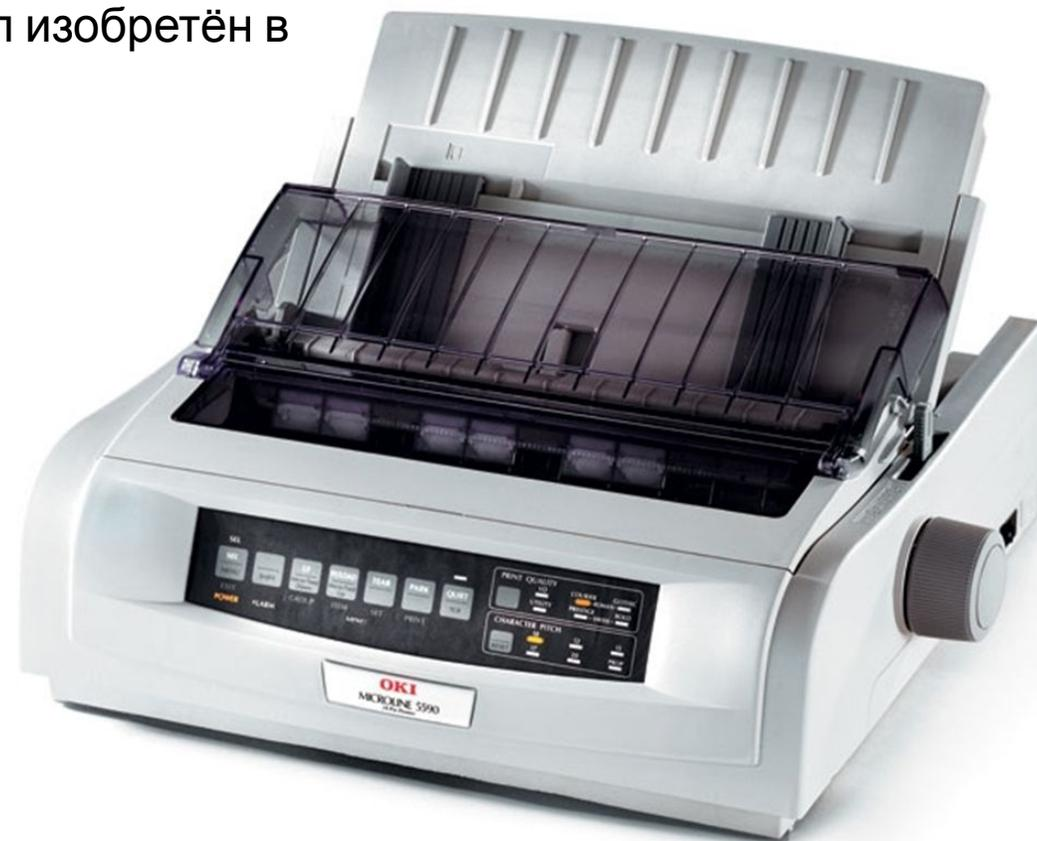
Последовательно-матричные принтеры отличаются по устройству от других матричных принтеров. Их печатающий механизм состоит из картриджа с красящей лентой и печатающей головки с игольчатой матрицей.
