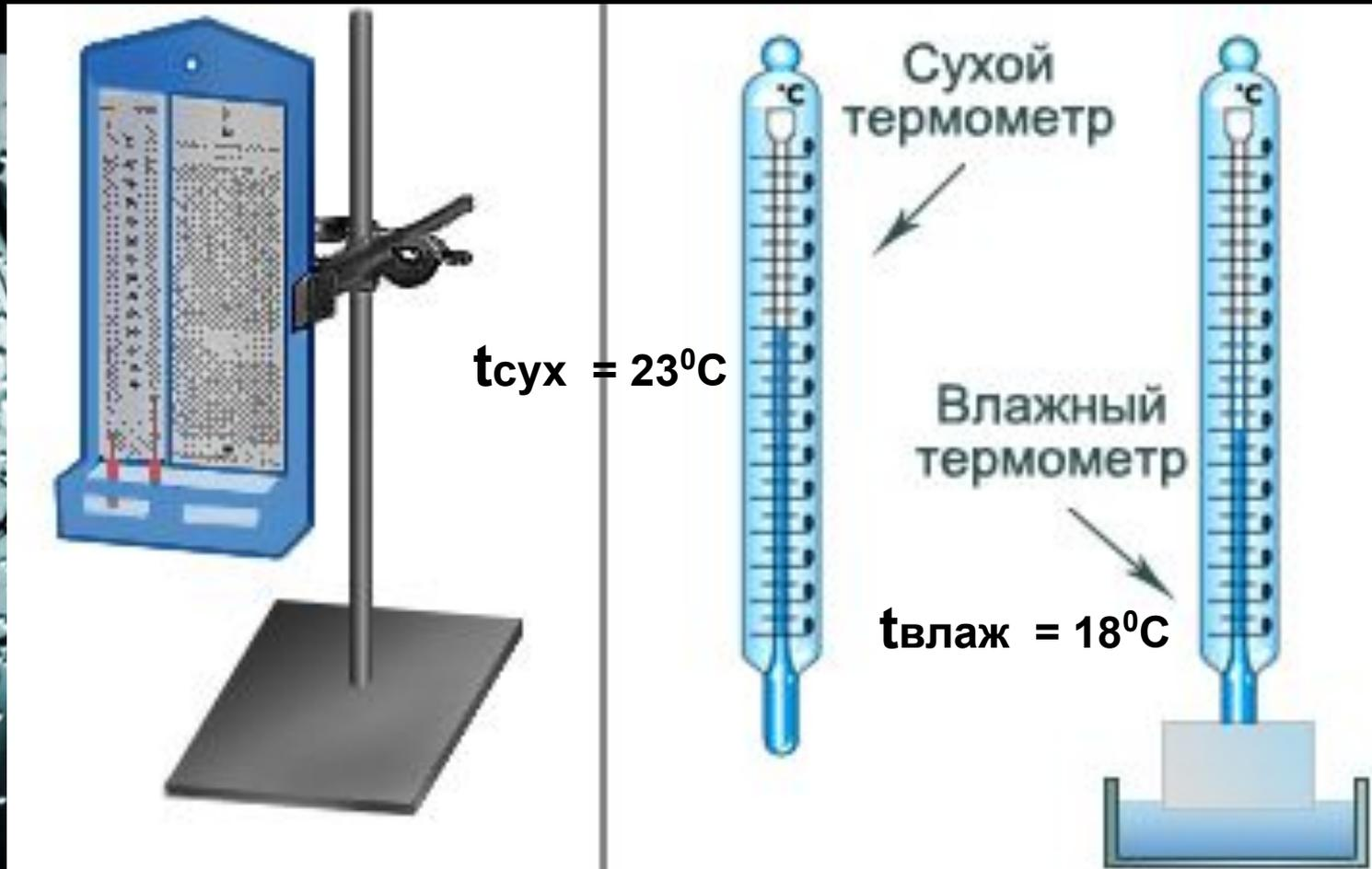
По разнице температур сухого и влажного термометров температуре сухого термометра устанавливают влажность воздуха по *психрометрической таблице*.
