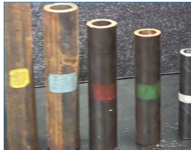
Цветовая маркировка муфт для арматуры разного диаметра
