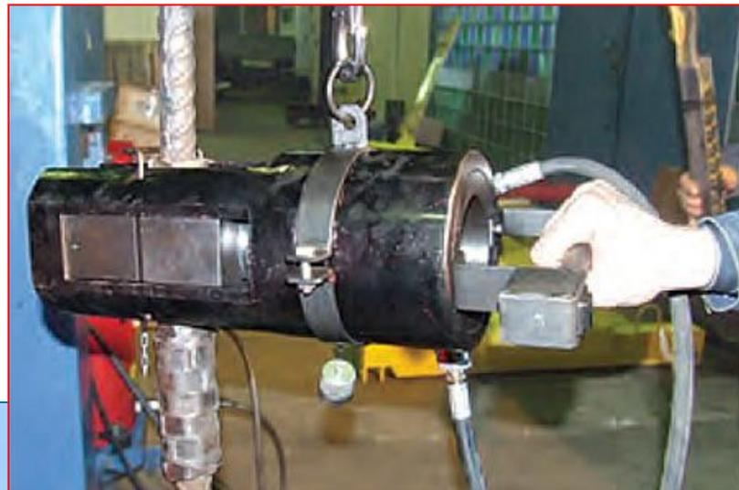
Совместно с НИИЖБ были созданы обжимные прессы СН - 50/80 и СН – 90/80 для стыковки арматуры периодического профиля от  $\varnothing 16$  мм до  $\varnothing 36$ мм. Инструмент успешно применяется в России.
