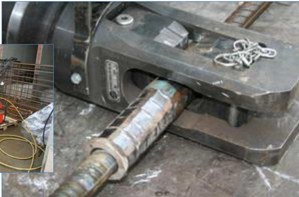
Механические соединения арматуры с использованием муфт и гидравлических обжимных прессов СН -50/80, СН – 90/80 могут использоваться в ЖБ конструкциях, в которых соединения внахлестку или сварка не допускаются или не применяются по конструктивным соображениям.
