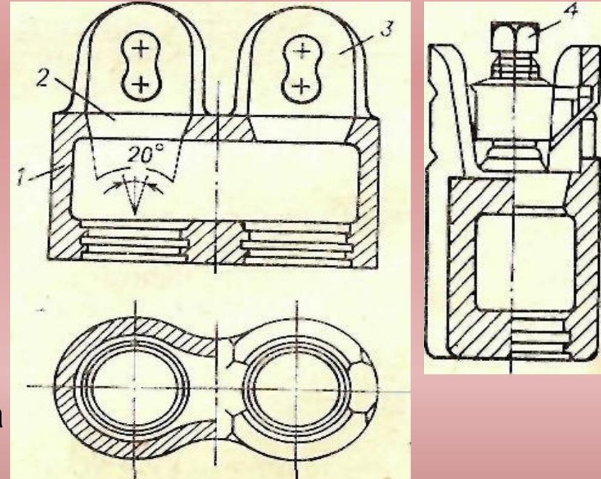
Трубные подвески служат для предотвращения провисания труб потолочного экрана.
